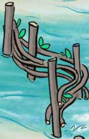
**Buhne aus Weidengeflecht:** Weidenzweige werden für den Bau von Strömungsenkern eingesetzt. Oft wachsen daraus wieder Weidengebüsche. Du brauchst ein paar dickere Zweige als Setzstangen, die du in den Schlamm oder Sand bohrst. Dazwischen flechtest du dünne Weidenzweige.
